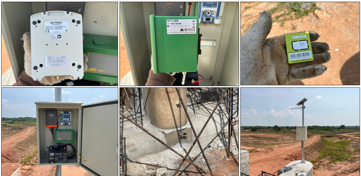
รูปที่ 1-23 ระบบโทรมาตรตรวจวัดระดับน้ำ (กลางน้ำ)
