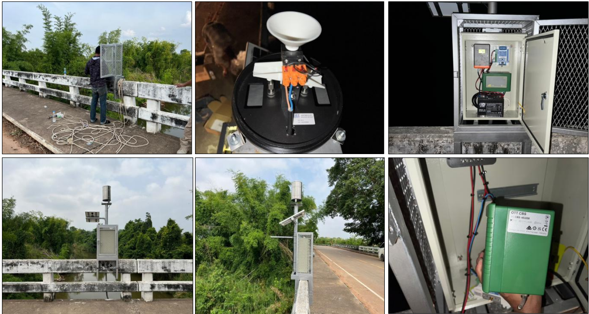
รูปที่ 1-22 ระบบโทรมาตรตรวจวัดระดับน้ำ (ท้ายน้ำ)
