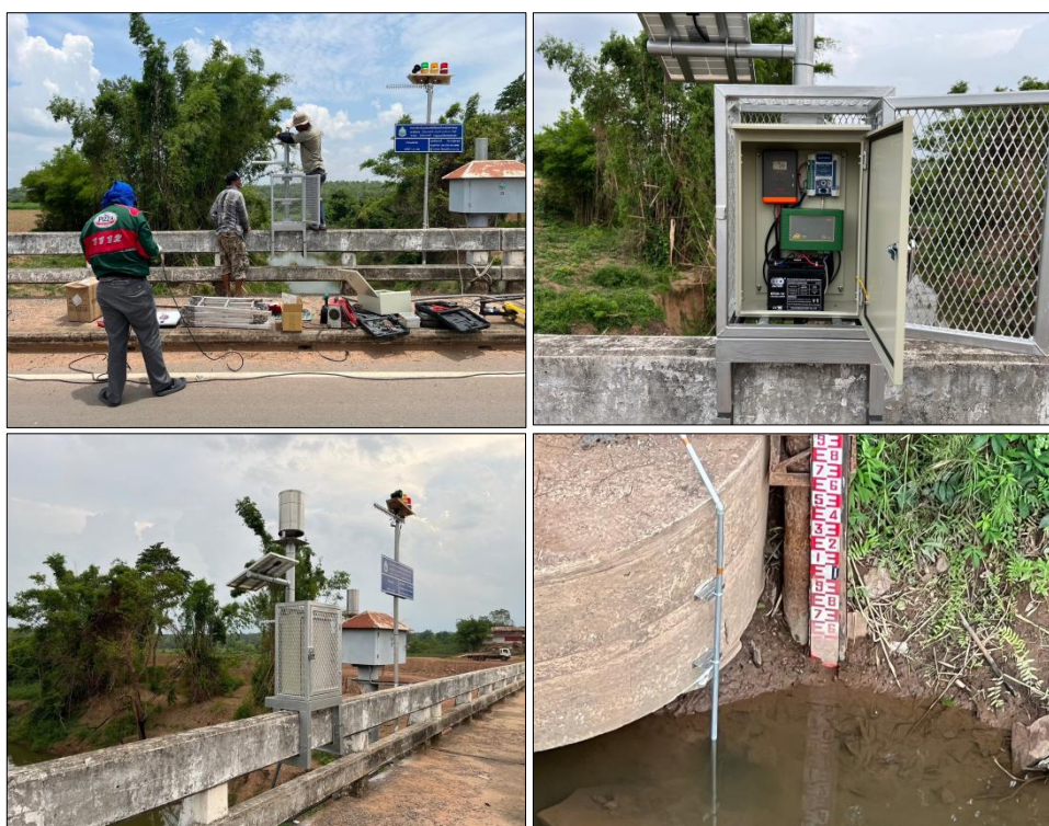
รูปที่ 1-21 ระบบโทรมาตร ตรวจวัดระดับน้ำ (เหนือน้ำ)
